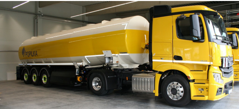
Cisternový návěs typu 3S4304 podle konstrukčního popisu Shell
